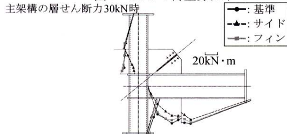
図6 柱梁の負担曲げモーメント分布
