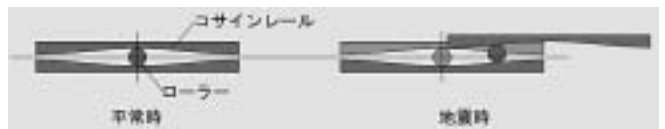
コサイン・レール支承の機構
