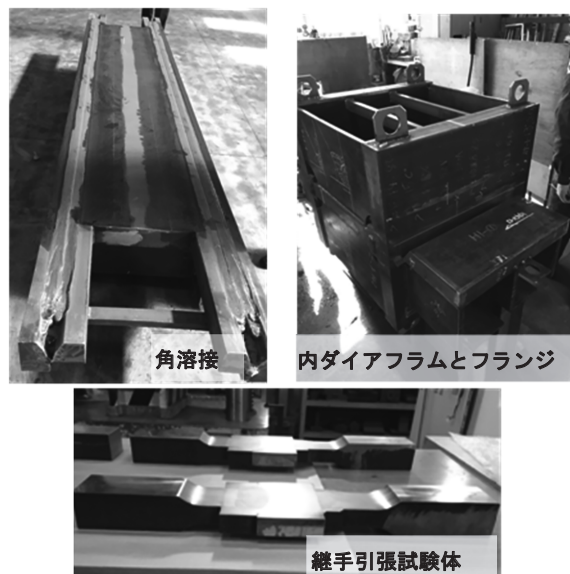
写真7 溶接施工試験および機械試験
