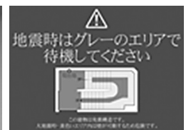
写真12 屋内避難階段 （階段室壁の稼働範囲を色分けして表示） （写真中央のグレーの線は免震水平スリットの位置を示す）
