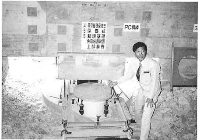
写真－6 免震部材横引きセット法の説明をされている青木工事に
