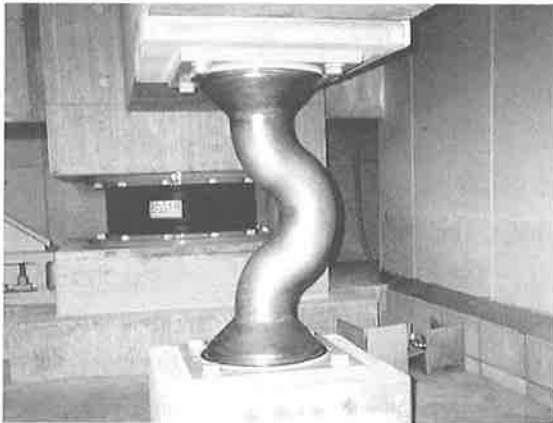
写真-2 鉛ダンパーと積層ゴム
