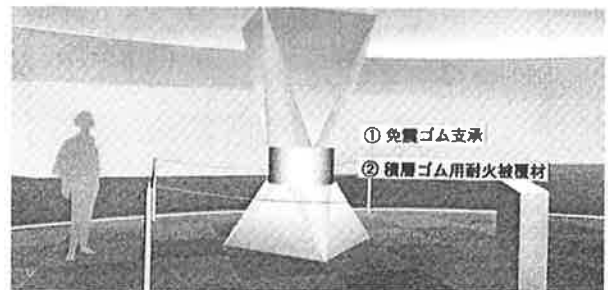
図-10 免震独立柱イメージ
