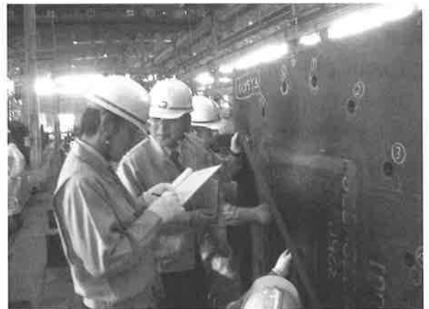
ベース・プレートのひずみ計測
