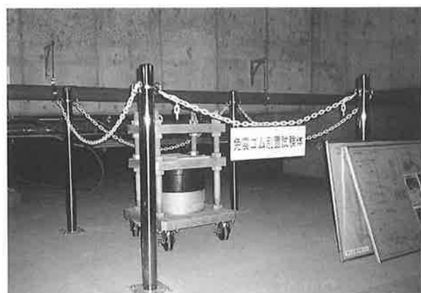
写真-12 積層ゴム別置き試験体設置状況
