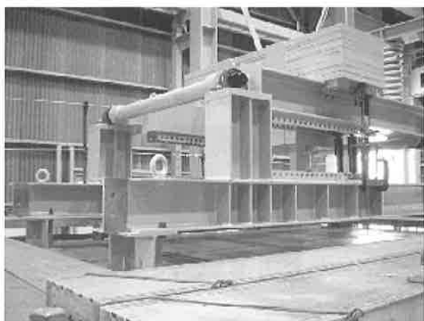
図9 上下方向TMD制振装置
