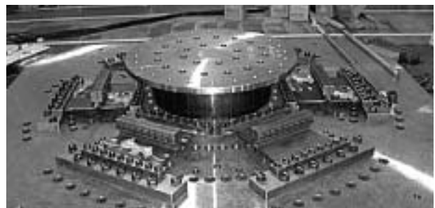
■写真1 1/2縮小模型試験体
