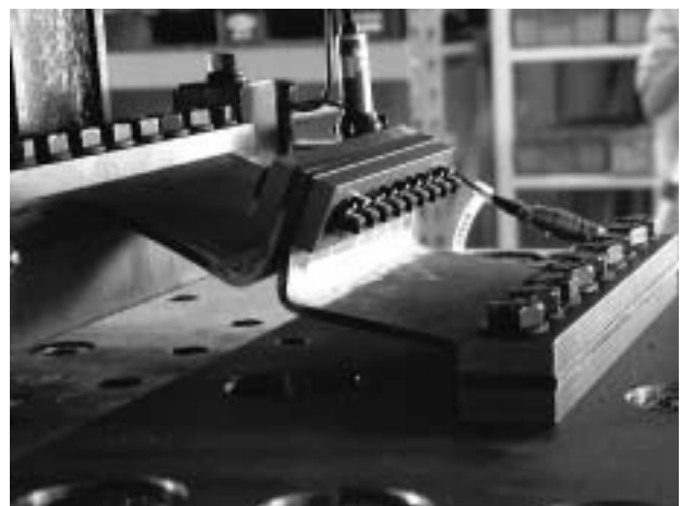
■写真2 ウイングプレートの加力実験状況
