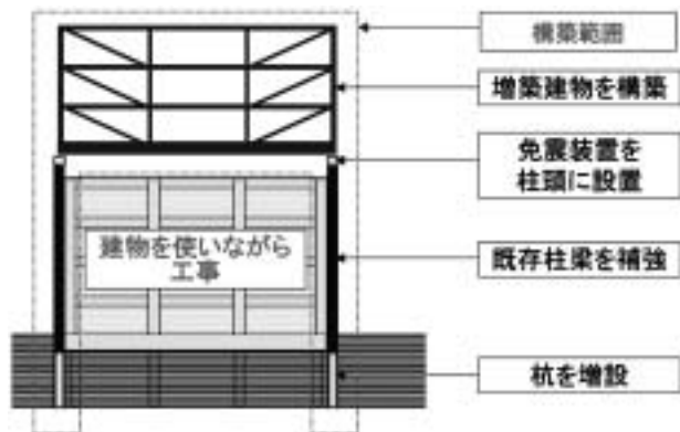
図6 増築構法の概要図
