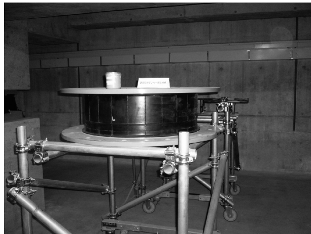
写真13 天然ゴム系積層ゴムの別置試験体
