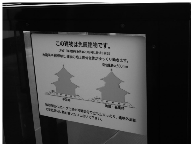
写真14 免震建物を示す掲示板
