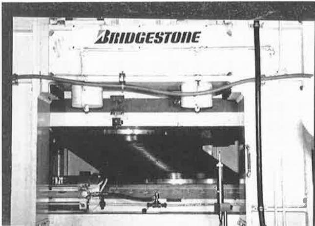
写真一3 水平方向載荷試験状況
