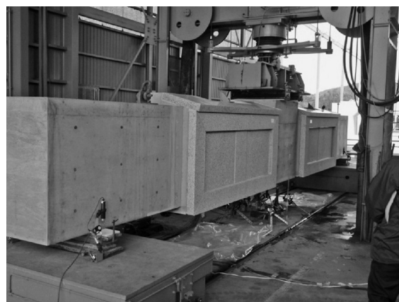
写真2 石先付けPCa梁の実大試験状況
