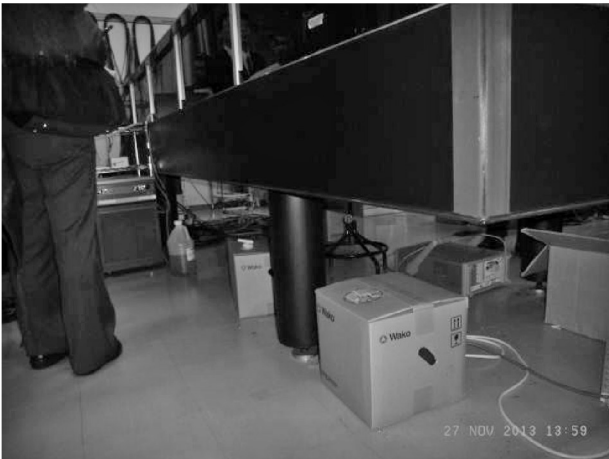
写真7 レーザー装置の下部架台の固定状況
