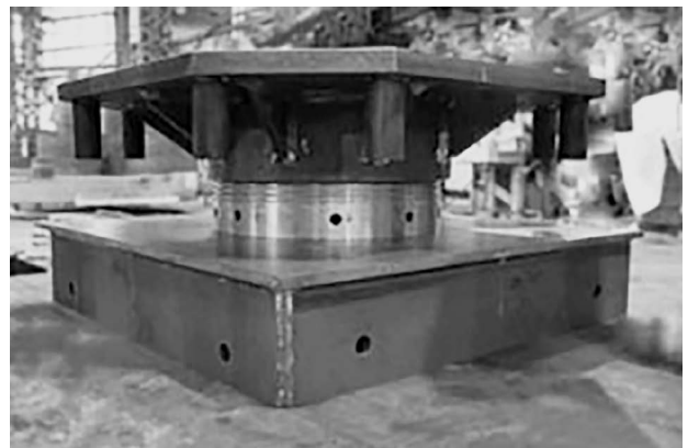
写真2 免震装置プレロード機構（鋼製支持部材）
