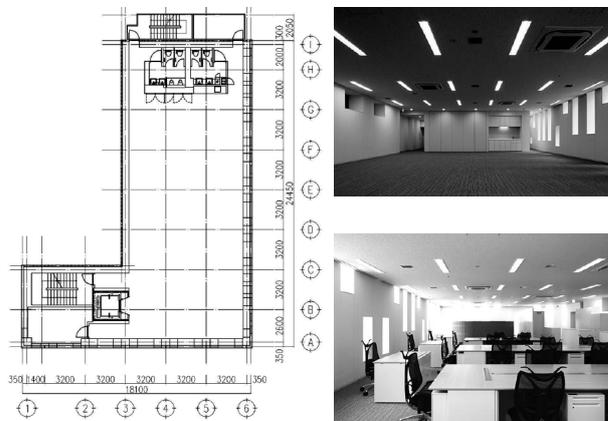
図5 小規模無柱オフィスの実現
