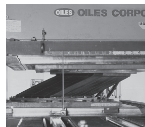
大型試験機によるLRBの大型変形性能試験
