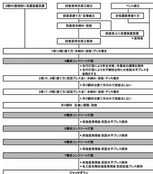
図11 高層部施工フロー
