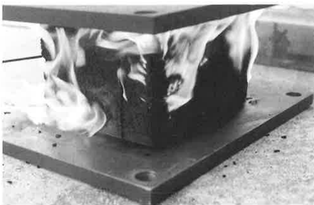
写真-1 積層ゴムの燃焼
