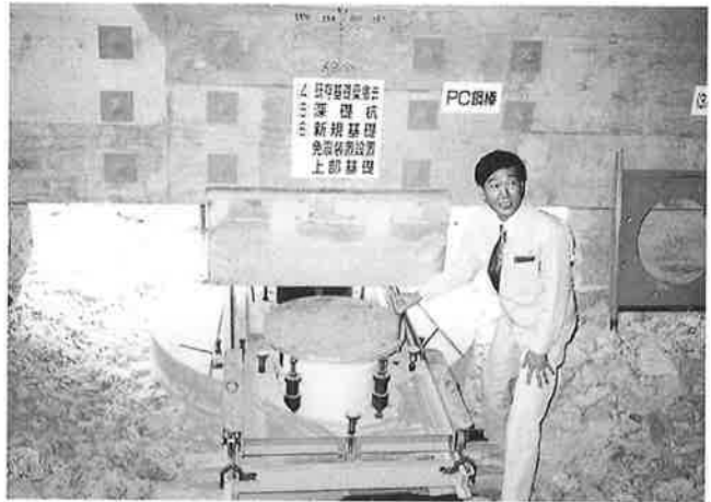
写真—6 免震部材横引きセット法の説明をされている青木工事に
