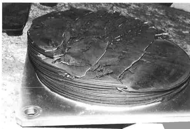
写真-1 積層ゴム破断面の状態
