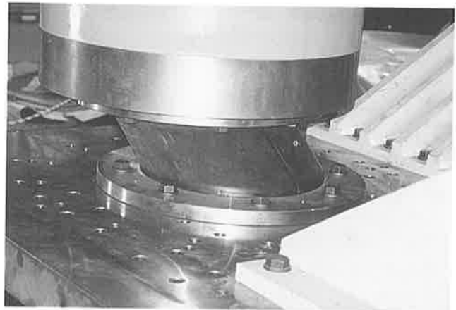
写真-2 積層ゴムの2方向変形状態
