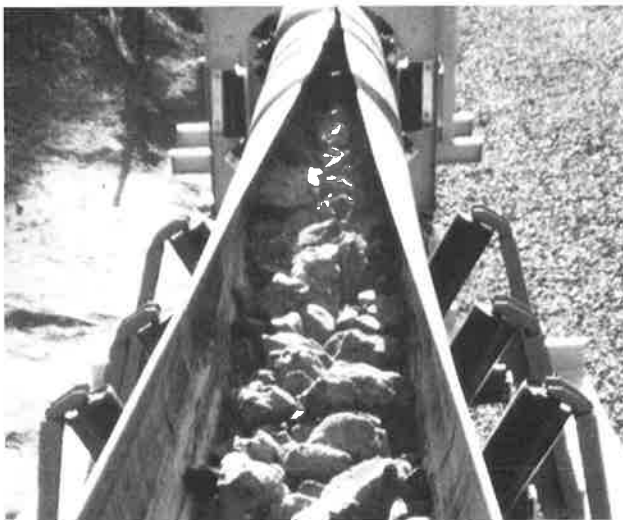
図2 パイプコンベアベルトの使用される様子
