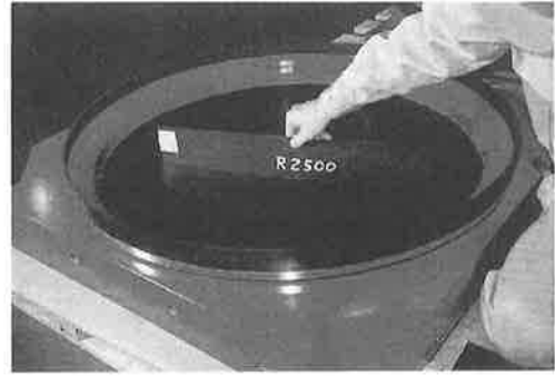
(上・下球面板の曲率半径)
