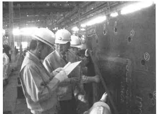
ベース・プレートのひずみ計測
