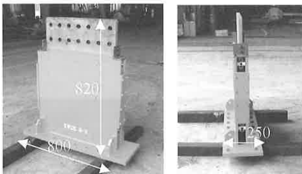
写真-2 2層平板型粘弾性ダンパー
