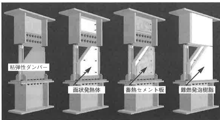
図-4 温度管理システムの構成
