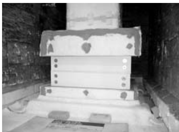
写真4 認定予備試験—载荷加熱試験
