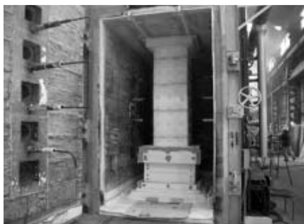
写真3 認定予備試験—载荷加熱試験
