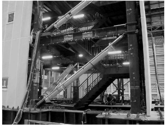
写真4 構造物に設置されたオイルダンパー
