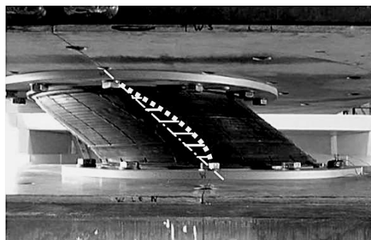
図2 HDR φ700 2方向加力時のねじれ変形状態
