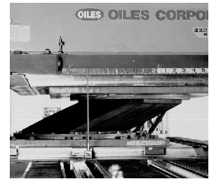
大型試験機によるLRBの大変形性能試験
