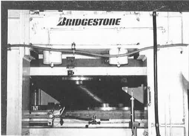
写真一3 水平方向載荷試験状況
