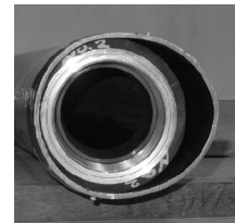
写真2 摺動部の局所変形
