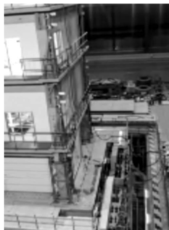
免震建物の擁壁衝突実験（E-Defense）
