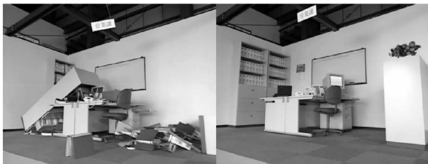
写真2 実大室内試験体による振動実験
