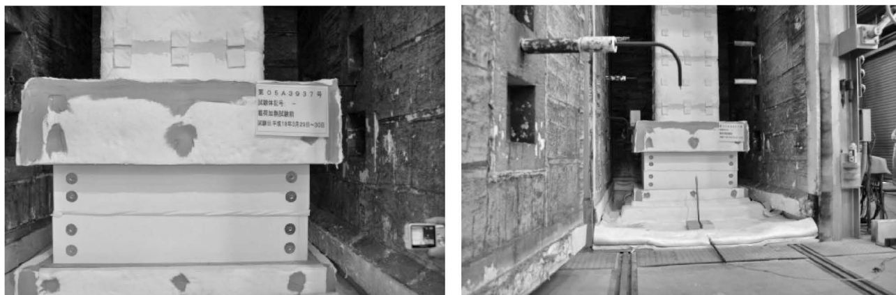
免震支承用耐火被覆システムの耐火試験（建材試験センター）
