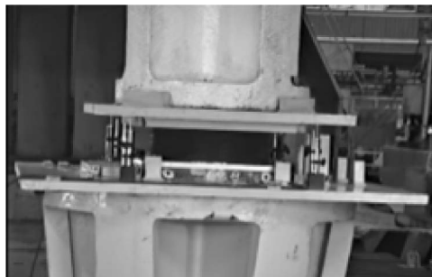
天然ゴム系積層ゴム支承（φ500）の圧縮破壊試験
