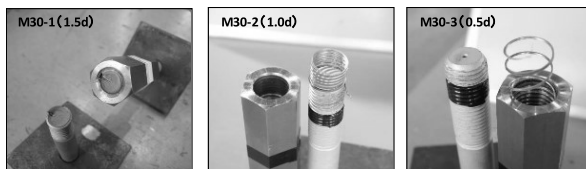
Photo. 1 螺合長さ別引張試験 試験後の状況
