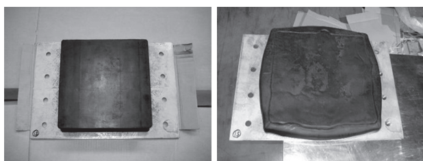
図15 免震フェンダー外観（左：出荷時、右：圧縮試験後）
