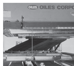
大型試験機によるLRBの大型変形性能試験
